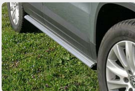
Estribos en plataforma de aluminio. Tipo TUBE. 072.VW-51781-O
