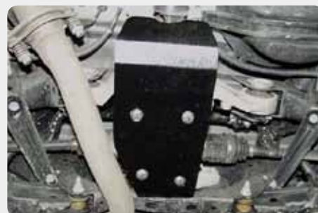
Protector de reductora SHERIFF. 190.24.0892 - acero 190.24.0893 - aluminio
