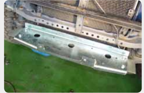
Base de cabestrante "oculta" para instalar con parachoques de origen.
