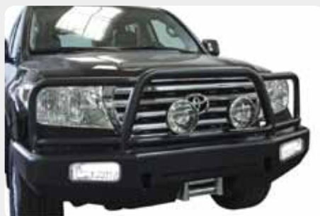
Parachoques frontal con base de cabestrante y con huecos para faros antiniebla. Versión África. 189.9319
