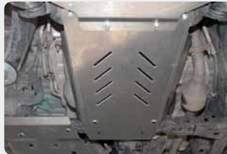
Protector de tr nsfer y caja de cambios SHERIFF. 190.24.1271 - acero 190.24.1276 - aluminio
