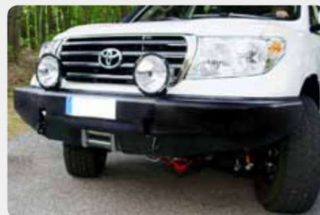
Parachoques frontal con base de cabestrante y sin huecos para faros. 189.9306
