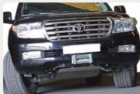
Base de cabestrante "oculta" para instalar con parachoques de origen. 189.9333
