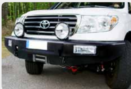
Parachoques frontal con base de cabestrante y con huecos para faros. 189.9305
