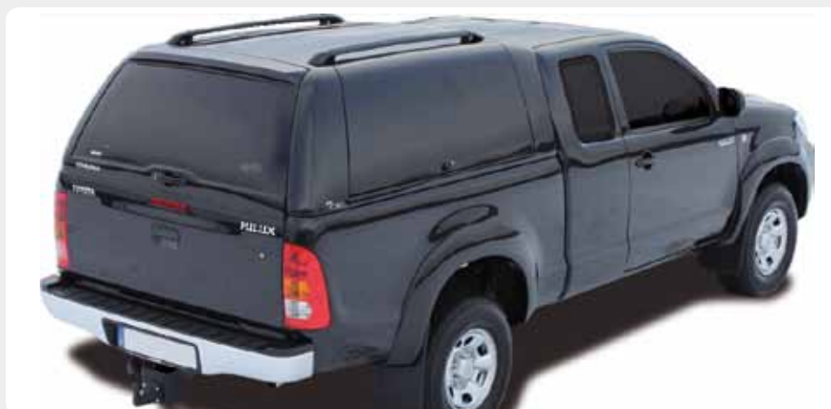
HardTop de trabajo ALPHA CM2, en fibra. Ventanas de apertura lateral.
