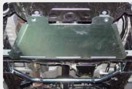
Protector de caja de cambios. 189.5570 - acero zincado 189.5571 - duraluminio
