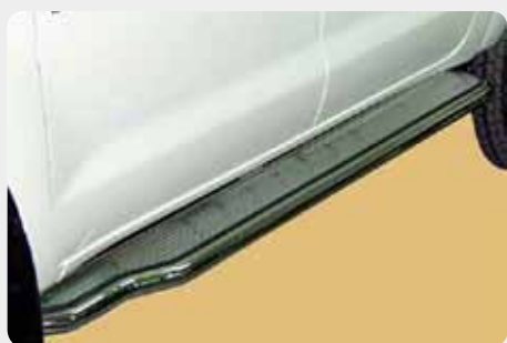
Estribos en plataforma de aluminio (estriado) con tubo Ø50mm. * Sólo modelos doble cabina. 189.5532 - inox 189.5533 - negro
