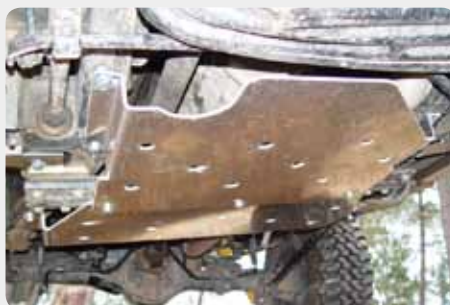
Protector de transfer. 189.5572 - acero zincado 189.5573 - duraluminio
