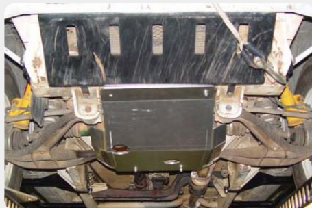
Protector de diferencial y cárter. 189.2223 - acero zincado 189.1793 - duraluminio
