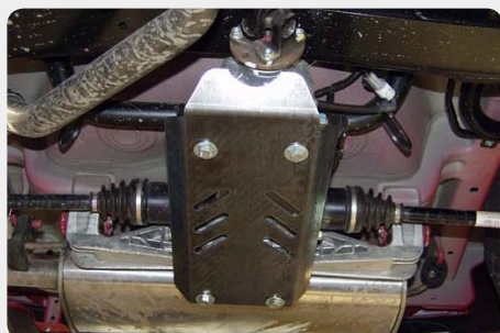
Protector de reductora SHERIFF. 190.23.0997 - acero zincado 190.23.1134a - aluminio
