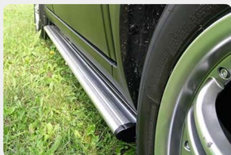
Estribos en plataforma de aluminio. Tipo TUBE. 072.FI-51206-O
