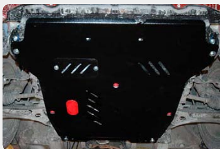
Protector de cárter y caja de cambios SHERIFF. *Sólo para motores 1.5/1.6/4x4 190.23.0931 - acero zincado 190.23.0966 - aluminio
