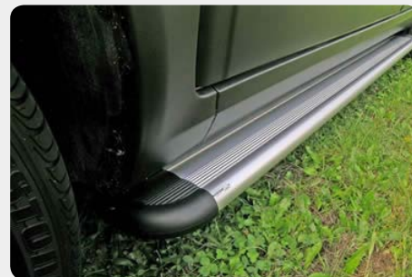
Estribos en plataforma de aluminio. Tipo S50. 072.FI-51206-I
