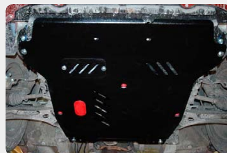
Protector de cárter y caja de cambios SHERIFF. *Sólo para motores 1.9TD 190.23.1263 - acero zincado 190.23.1336 - aluminio
