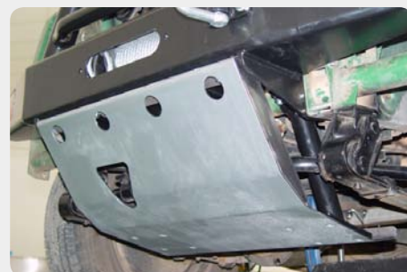
*Protector de barras de dirección, para instalar en parachoques frontal con base decabestrante.
