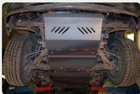
Protector de cárter SHERIFF. 190.29.0915 - acero zincado
