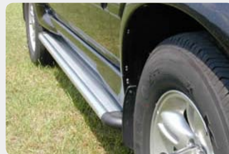
Estribos en plataforma de aluminio. Tipo S50. 072.SA-50744-I
