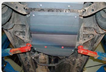
Protector de caja de cambios SHERIFF. 190.29.0914 - acero zincado
