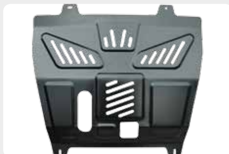
Protector de cárter y caja de cambios SHERIFF. 190.15.1583 - acero 190.15.1353 - aluminio
