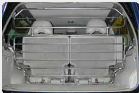
Separador de carga interior. * Sólo para modelos 3 puertas. 072.PO-55623
