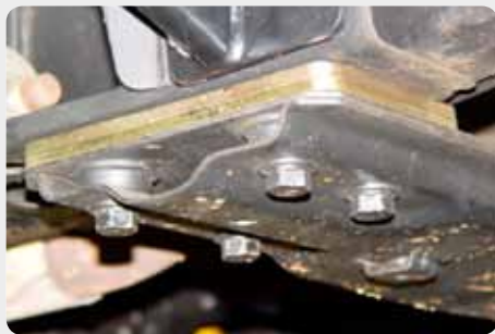
Separador de caja de cambios (gear-box). Varias medidas. 189.1572
