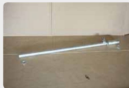
Barras de dirección reforzada con soporte de amortiguador de dirección. 007.BDR003 - delantera 007.BDR004 - trasera
