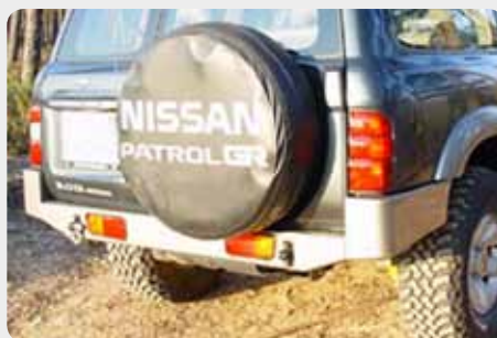
Parachoques trasero. 189.3604 - con huecos para pilotos 189.3666 - sin huecos para pilotos
