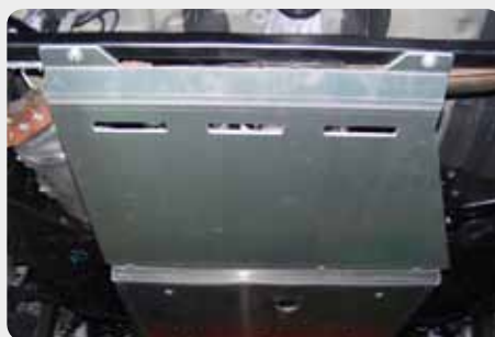
Protector de tr nsfer. 189.5235.3 - acero zincado 189.5254.3 - duraluminio
