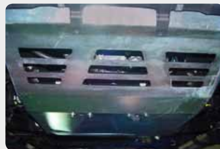
Protector de cárter y barras de dirección. 189.5235.1 - acero zincado 189.5254.1 - duraluminio
