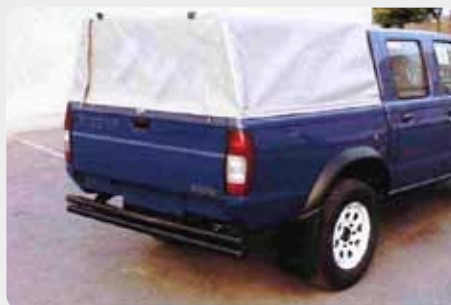
Toldo de lona con estructura en arcos.
