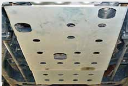
Conjunto de protecciones: c rter + diferencial + tr nsfer.
