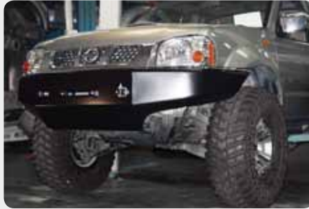
Parachoques frontal con base de cabestrante y sin huecos para faros antiniebla.
