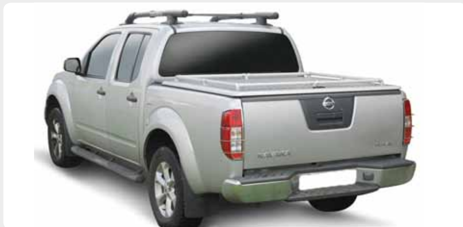
Cubierta plana FOURWHEELER en aluminio. 101.NNI-1004 - doble cabina 101.NNI-1004EX - extra cabina
