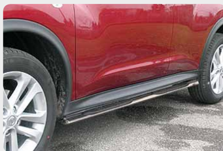
Estribos en tubo inox sección oval, con pisantes 072.JU-51892-X - doble cabina
