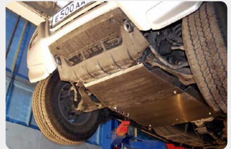
Protector de cárter y caja de cambios SHERIFF. 190.14.0750 - acero zincado 190.14.0674 - aluminio
