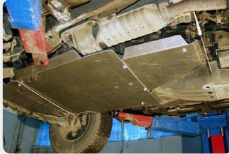
Protector de cárter y caja de cambios SHERIFF. *Modelos gasolina. 190.14.0750 - acero zincado 190.14.0674 - aluminio
