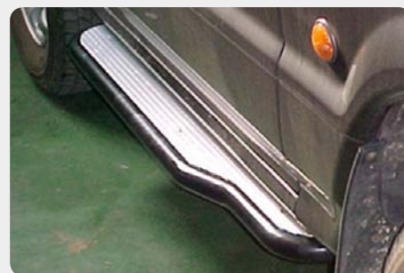
Estribos en plataforma con tubo.
