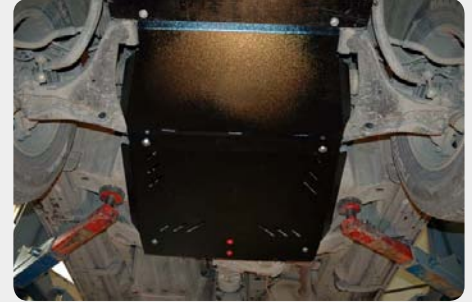
Protector de cárter y caja de cambios SHERIFF. *Modelos diesel (Di.D) 190.14.1139 - acero zincado 190.14.1140 - aluminio
