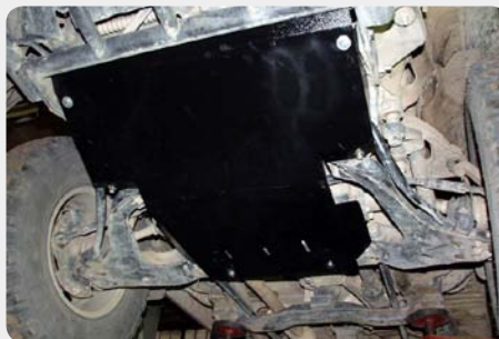
Protector de c rter SHERIFF. 190.14.0636 - acero zincado
