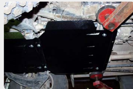
Protector de caja de cambios SHERIFF. 190.14.0637 - acero zincado
