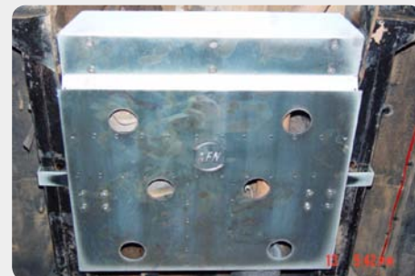
Protector de tr nsfer. *S lo para T200 189.1687 - acero zincado
