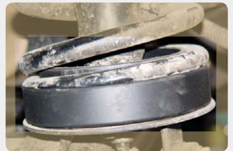
Casquillo de elevaci n de muelles, 30mm. 189.50.1 - delantero
