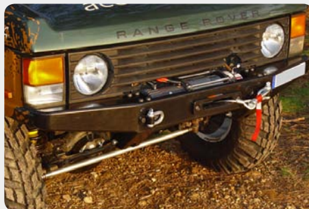
Parachoques frontal con base de cabestrante. 189.1672
