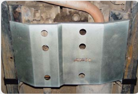
Protector de tr nsfer. *S lo para T300 189.1673 - acero zincado
