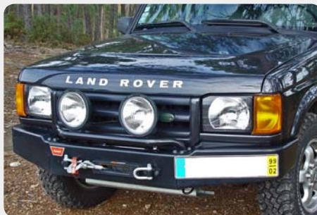
Parachoques frontal con base de cabestrante. 189.5103
