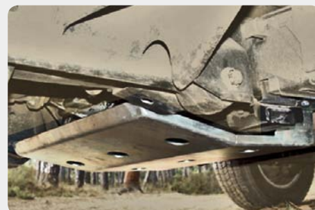
Protector de tr nsfer. 189.5102 - acero zincado
