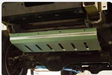
Protector de barras de dirección. 189.5101 - acero zincado
