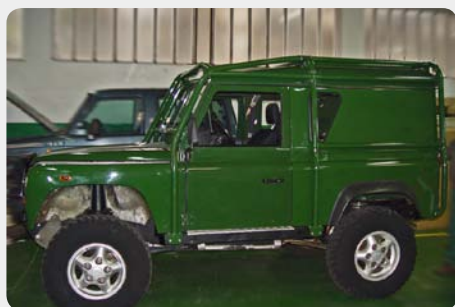
Rollbar (barras antivuelco) exterior en tubo negro Ø60mm. *Sólo para carrocería corta con techo metálico. 189.10029
