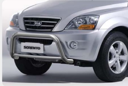
Defensa central inox baja sin grabación, Ø60mm. Homologación CE.
