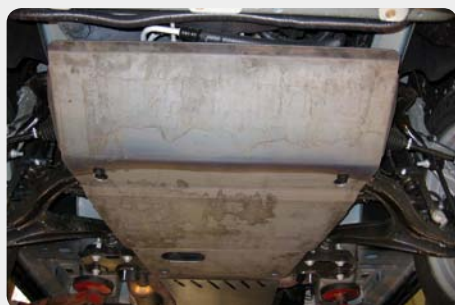
Protector de cárter SHERIFF. 190.04.0972 - acero zincado
