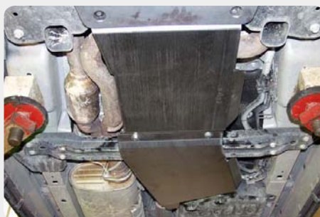
Protector de caja de cambios SHERIFF. 190.04.0964 - acero zincado
