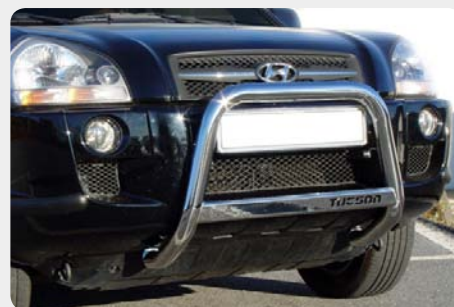
Defensa central inox baja, Ø60mm. Homologación CE. 189.1464.CE - con grabación
