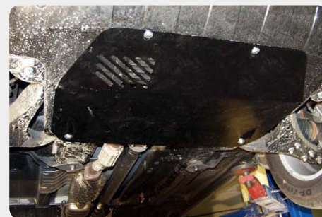
Protector de cárter y caja de cambios SHERIFF. 190.10.0646 - acero zincado 190.10.1116 - aluminio
