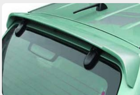
Alerón/Spoiler de techo con tercera luz de freno integrada. 072.HT-51125
