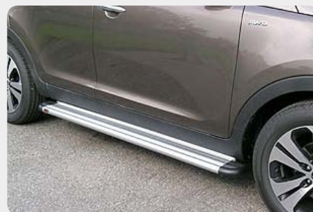
Estribos en plataforma de aluminio. Tipo S50.
