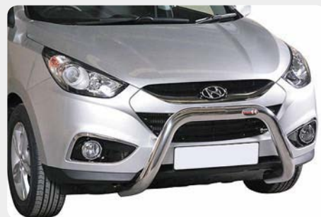
Defensa central inox baja sin travesía, Ø70mm. Homologación CE.
