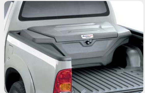
Caja de herramientas AEROKLAS en ABS. Modelo "Gladiator". 001.1000-L
