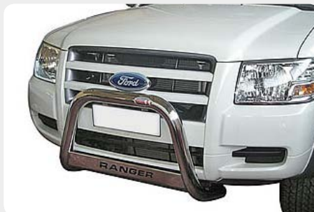
Defensa central inox baja con grabación. Homologación CE. * Sólo para Ranger [2006 - 2009] 072.FO-31003 - Ø60mm
