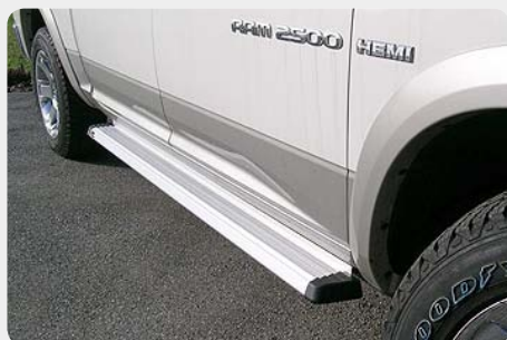
Estribos en plataforma de aluminio. Tipo S25. 072.DO-51813-M
