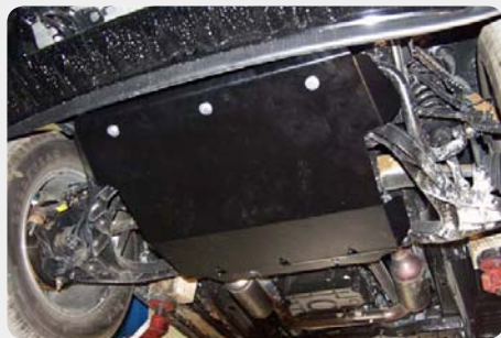
Protector de cárter SHERIFF. 190.04.0974 - acero zincado
