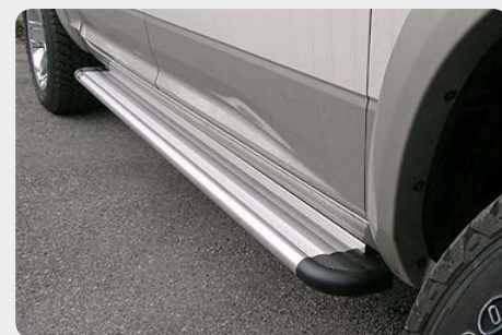
Estribos en plataforma de aluminio. Tipo S50. 072.DO-51813-I
