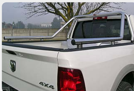
Rollbar (barras antivuelco) en tubo inox, Ø60mm. 072.DO-51812-L
