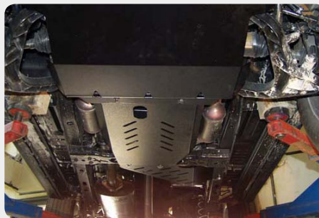
Protector de caja de cambios y caja de cambios SHERIFF. 190.04.0975 - acero zincado
