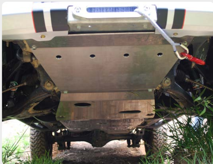
Protecciones: cárter + transfer + caja de cambios (Isuzu D-Max)
