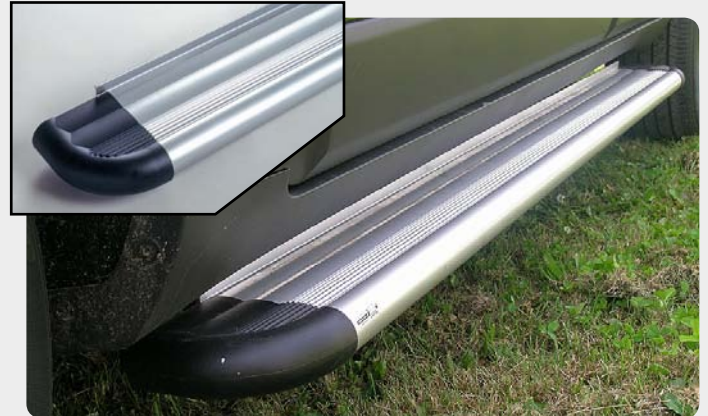
Estribos en plataforma de aluminio. Tipo S50. Consultar catálogo por marcas
