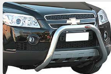
Defensa central inox baja sin travesía, Ø70mm. Homologación CE. 072.CC-33001
